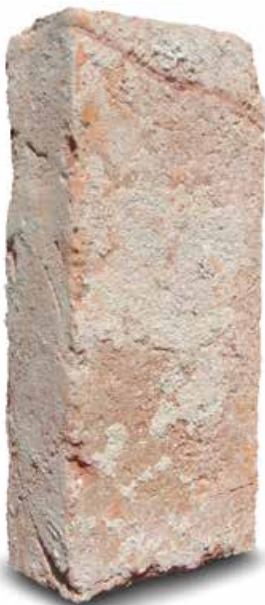
Mittelalterliche, sogenannte "Klosterziegel" hatten eine Größe von 34 x 17,5 x 7,5 cm
